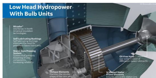
Figura 5-8 - turbina de bulbo (fuente: GE)
