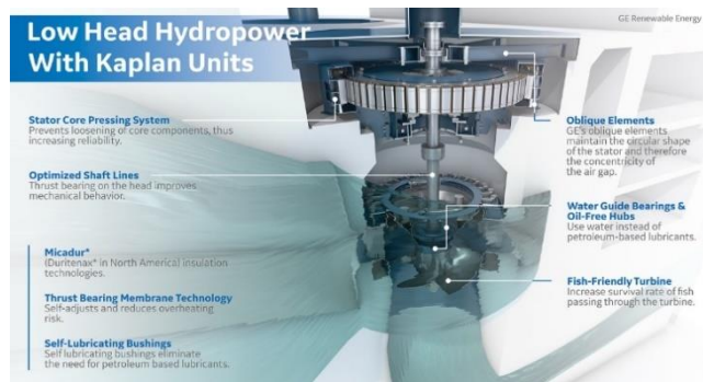
Figura 5-9 - Kaplan turbina (fuente: GE)
